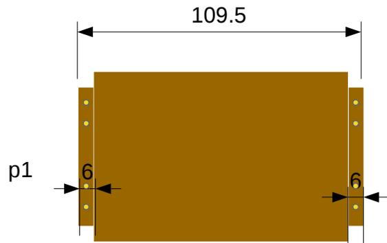
Assemblage planches avec recouvrement.
